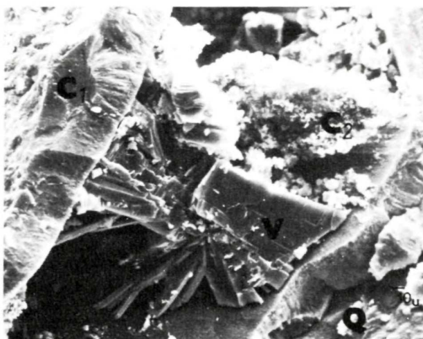
Obr. 2. Paragenéza minerálov v stmelenom pieskovom filtrí. Metakoloidný karbonát ( C_1 ) obaľuje zrná kremeňa pieskového filtra (Q). Vivianit (V) spolu s mikrokryštalickým karbonátom ( C_2 ) vyplňa dutiny po metakoloidnom karbonáte.
